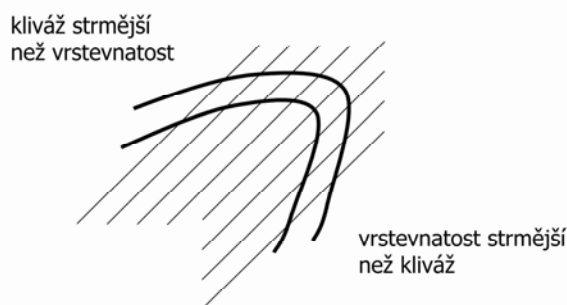
Obrázek 11.5: Vztah vrstevnatosti a kliváže je různý v překocném a nepřekocném rameni vrásky.
